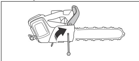
4. Serrez l'écrou du guide-chaîne à l'aide de la clé mixte et soulevez en même temps l'extrémité avant du guide-chaîne.
