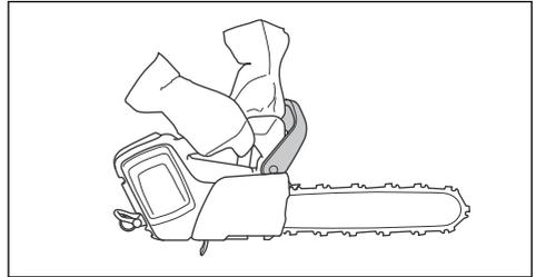
La protection anti-rebond réduit également le risque de contact avec la chaîne si vous lâchez la poignée avant.
