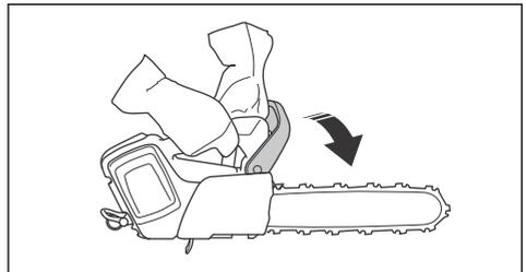
En position d'abattage, vous ne pouvez pas engager le frein de chaîne manuellement. Dans cette position, le frein de chaîne peut uniquement être serré par la fonction d'inertie.
