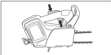
2. Appuyez sur le blocage de la gâchette de puissance vers l'avant (A) et vers le bas (B). Maintenez le blocage de la gâchette de puissance contre la poignée et vérifiez qu'il revient en position initiale quand vous le relâchez.
