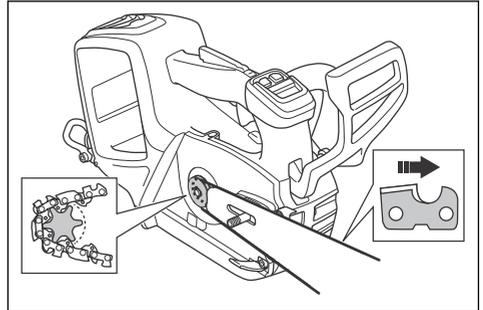
5. Assurez-vous que le bord tranchant des dispositifs de coupe est dirigé vers l'avant sur le dessus du guide-chaîne.
