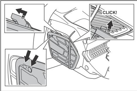
3. Poussez le couvercle de prise d'air vers la gauche jusqu'à ce que les orifices soient alignés.
