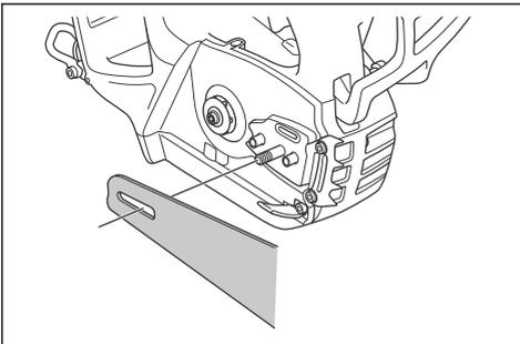
4. Guidez le guide-chaîne dans sa position la plus en arrière possible. Soulevez la chaîne de sciage au-dessus du pignon d'entraînement et placez-la dans la rainure du guide-chaîne. Commencez par le bord supérieur du guide-chaîne.
