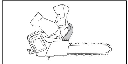
3. Faites tourner à puissance maximum et inclinez le poignet gauche vers l'avant pour serrer le frein de chaîne.
