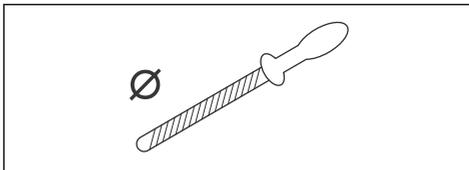
Il est difficile d'affûter correctement une chaîne sans équipement adapté. Utilisez un gabarit de lime recommandé Husqvarna. Il vous permettra de conserver des performances de coupe maximales et un risque de rebond minimal.
