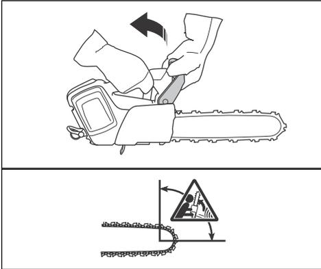
La façon dont le frein de chaîne est engagé dépend de la force du rebond et de la position du produit. En cas de rebond intense lorsque la zone de rebond est très éloignée de vous, le frein de chaîne est engagé par l'inertie relâchée. Si le rebond est faible ou si la zone de rebond est plus proche de vous, vous pouvez engager le frein de chaîne manuellement de la main gauche.
