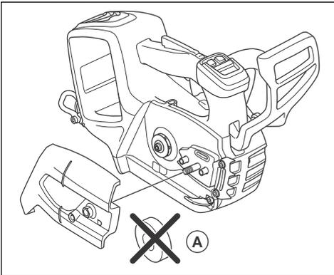
3. Placez le guide-chaîne au-dessus du boulon de guide-chaîne.
