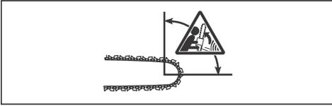
Le rebond se produit toujours dans le plan du guide-chaîne. Généralement, le produit est projeté contre l'opérateur, mais il peut aussi se déplacer dans une autre direction. C'est la façon dont vous utilisez le produit au moment du rebond qui détermine le sens du déplacement.
